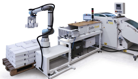
MBO CoBo Stacks zum Abstackeln gefalzter Signaturen (Foto: MBO)
