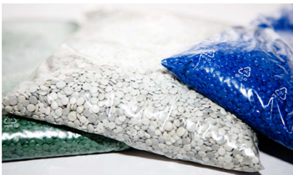
Granulate aus Weich-Polyethylen – Ausgangsmaterial für neue Kunststoffolie
